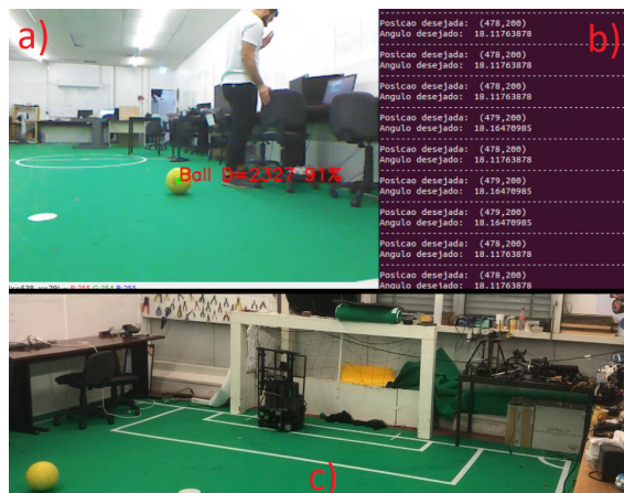
Figura 108: a) Imagem da Microsoft Kinect . b) Posição e orientação desejada. c) Posição e orientação real do robô na baliza. (Posicionamento e orientação - 3º teste)
