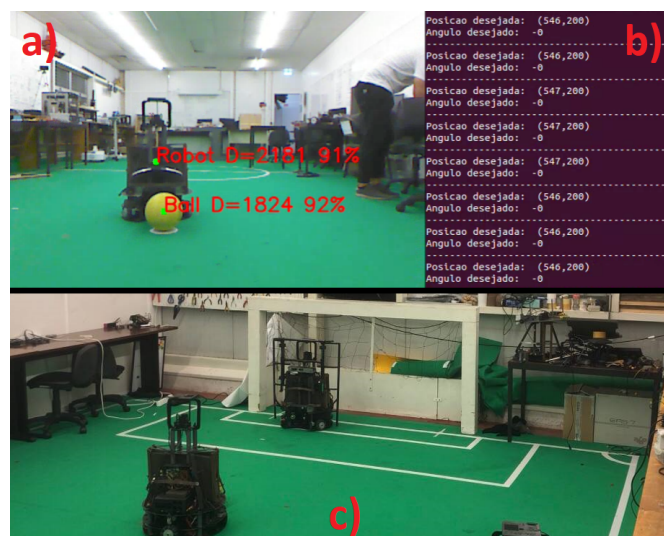
Figura 115: a) Imagem da Microsoft Kinect . b) Posição e orientação desejados para o robô. c) Posição e orientação real do robô na baliza. (Defesa do penáti - 1º teste)
