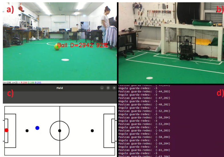
Figura 84: a) Imagem da Microsoft Kinect . b) Posição real do robô. c) Representação da localização do robô no campo. d) Coordenadas obtidas pelo robô em milímetros (x,y). (1º teste)
